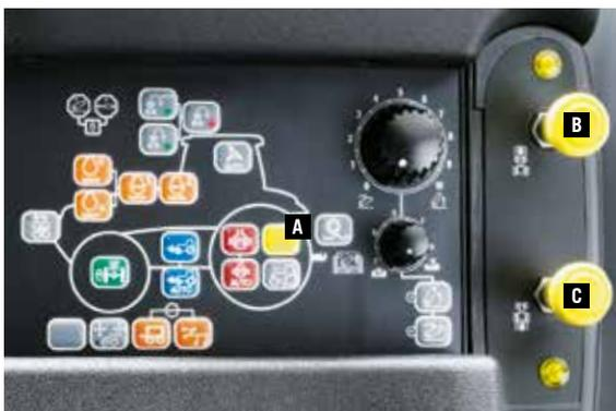
**A - Automatische Zapfwellenschaltung**
