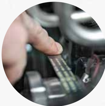
Kinderleichte Kontrolle des Keilriemens.
